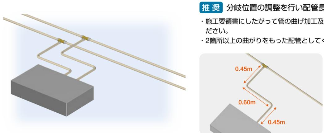
**推奨** 分岐位置の調整を行い配管長さを確保してください。
