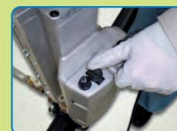
完全に穴が開いたことが確認できたら、モーターのスイッチを「OFF」にしてモーターを止めます。
