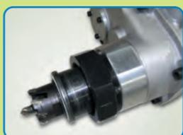
穿孔機のスピンドルに穿孔サイズと同径の切削刃を取り付け、スピンドルを最大まで引き上げます。
