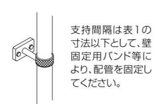
【天井あるいは壁に直接クリックバンドを取付ける場合】
