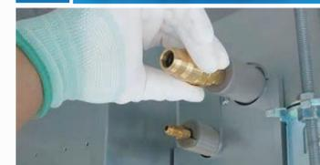
継手を機器の接続おねじに手で回し、回らなくなるまで締め込んでください。
