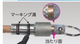
専用の標線ゲージに管を通し、指定の油性マジックで標線2本をマーキングしてください。
