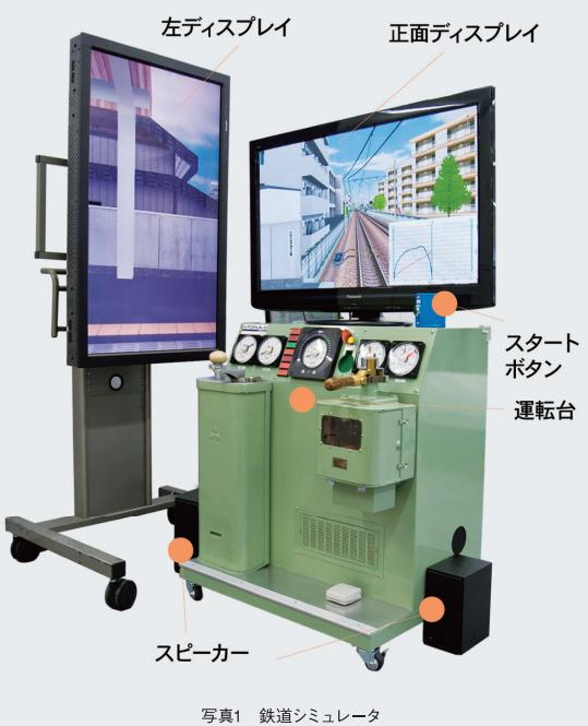
写真1 鉄道シミュレータ
