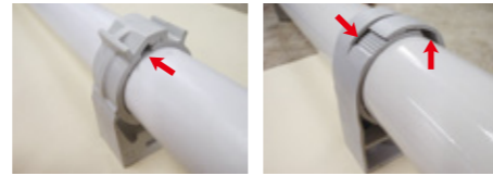
クリップの刃が一部噛み合っていない状態
